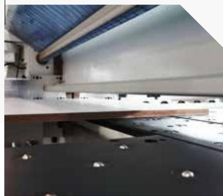
Le presseur intelligent à double système pneumatique assure le maintien parfait de la pile et réduit les temps d'usinage. La sécurité de l'opérateur est toujours assurée et même en cas de baisse de puissance, le presseur maintient sa position de sécurité.
