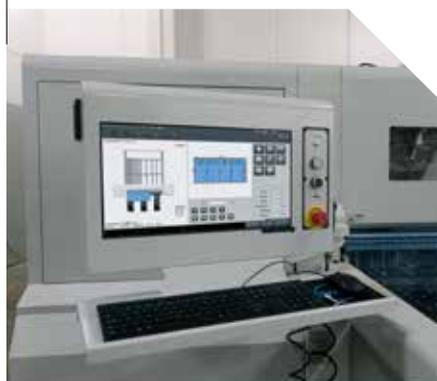
PC industriel, interface intuitive, gestion complète de la machine et guide de résolution des problèmes. Possibilité de gérer des lots grâce à l'étiquette codes-barres.
