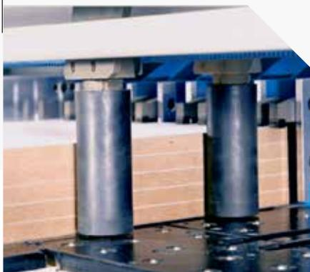
Haute précision d'usinage grâce au système d'alignement latéral à 2 rouleaux.
