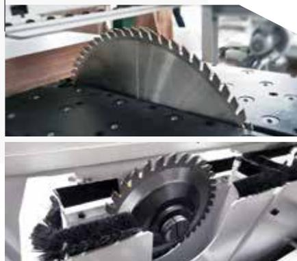
La coupe est précise grâce à l'inciseur et la lame principale contrôlés de façon indépendante. La lame optimise la hauteur de coupe de façon automatique en fonction de l'épaisseur de la pile.
