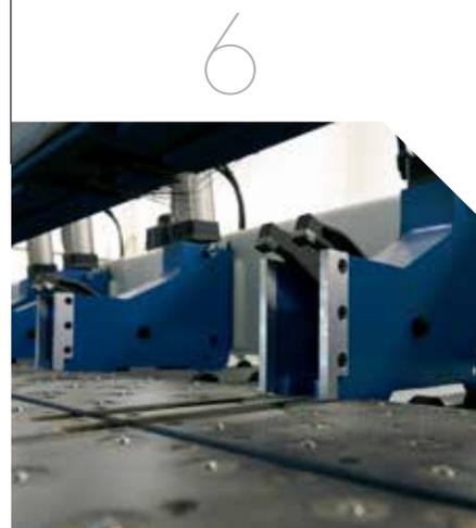
Stabilité et force de blocage grâce aux pinces compactes et rigides. La dimension minimum de coupe est de 34\*45mm. Possibilité d'ajouter jusqu'à 2 pinces supplémentaires en option.
